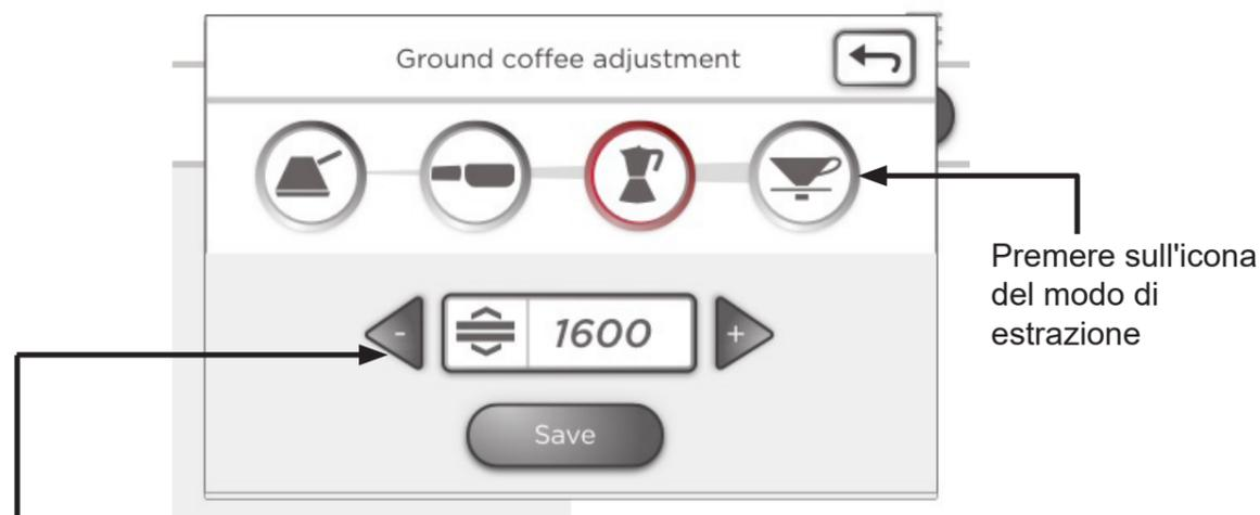
Usare le frecce per impostare il settaggio micrometrico del punto di macinatura
